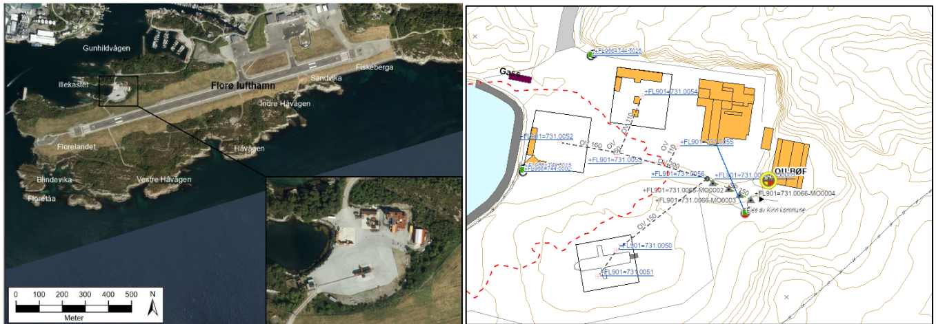
Figur: Høyre: oversikt over LH og plassering av BØF. Venstre: OV kart, stiplet sort linje viser OV-ledning, OU-BØF er oljeutskiller
